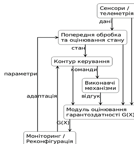
Рис. 2. Узагальнена архітектура системи управління БПЛА з інтеграцією модуля оцінювання гарантоздатності
