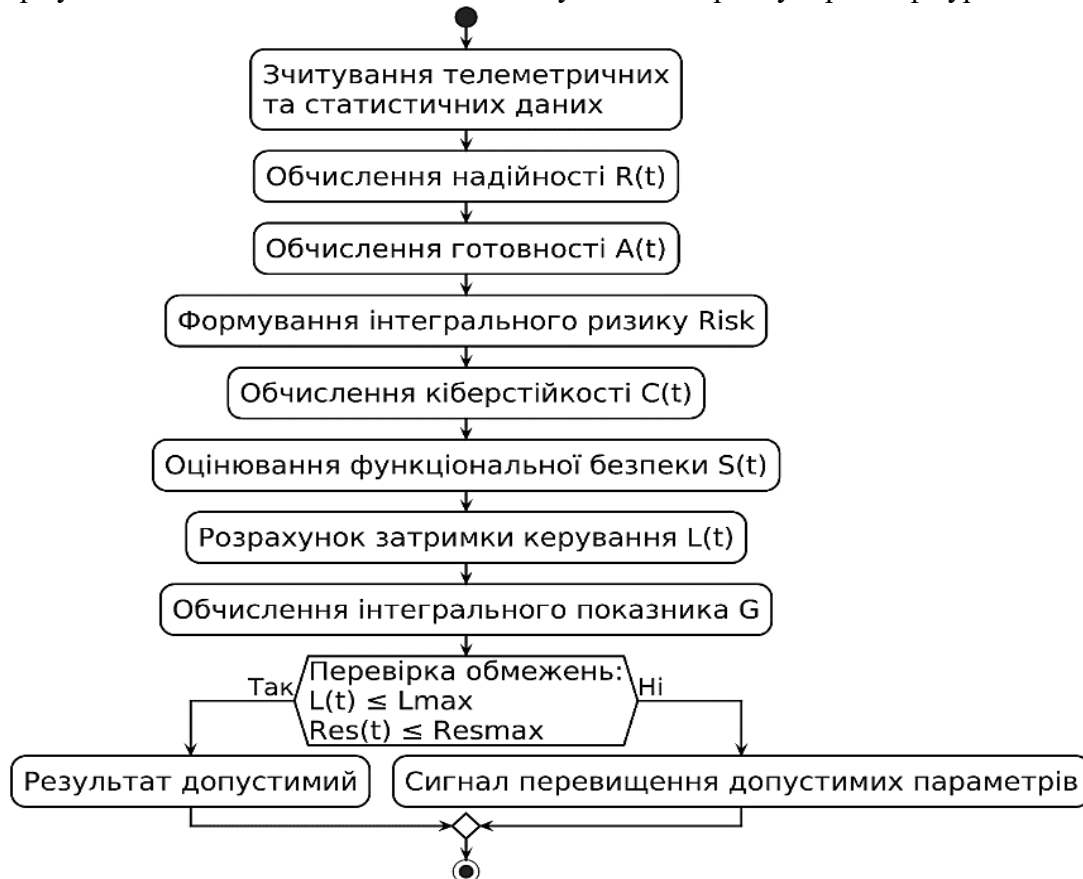
Рис. 3. Блок-схема алгоритму обчислення інтегрального показника гарантоздатності
