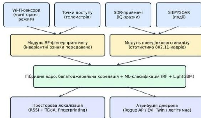
Рис. 1. Архітектурна схема гібридного методу просторово-мережевого пошуку та атрибуції об'єктів у Wi-Fi-середовищі / Architecture of the hybrid method
