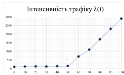
Рис.2. Приклад зміни інтенсивності трафіку під час DDoS-атаки
