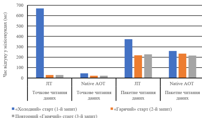
Рис. 1. Порівняльна характеристика часу відгуку при «холодному» та «гарячому» старті (мс)
