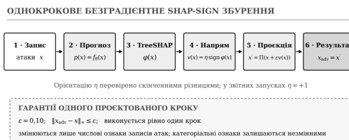
Рис. 2. Однокрокова процедура безградієнтного SHAP-sign збурення з перевіреною орієнтацією знака та проєкцією на множини допустимих значень
