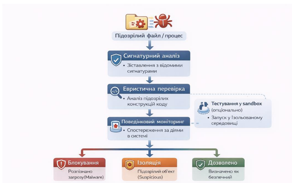
Рис. 1. Схема роботи системи виявлення шкідливих програм
