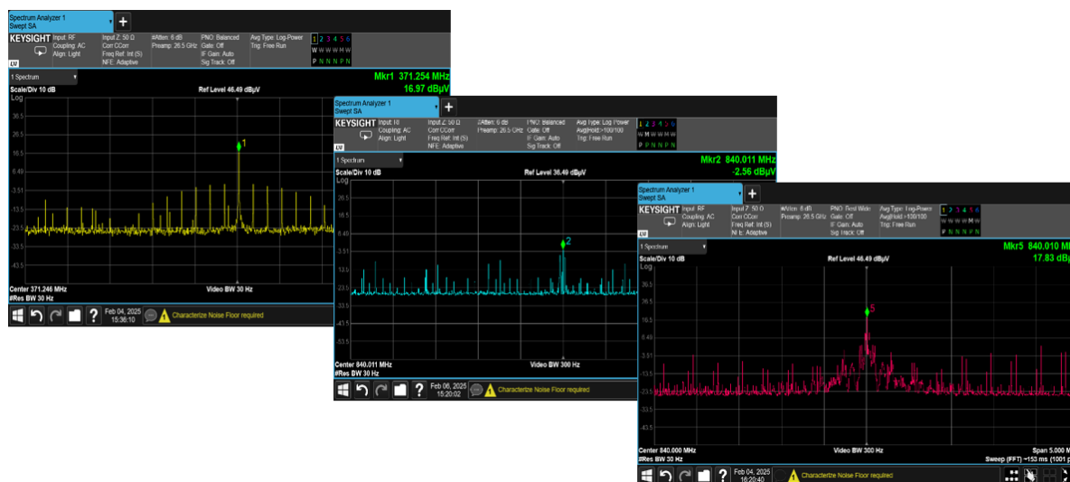
Рис. 5. Спектри інтермодуляційного випромінювання інтерфейсів монітора, принтера та USB під впливом сигналу ВЧН [18].
