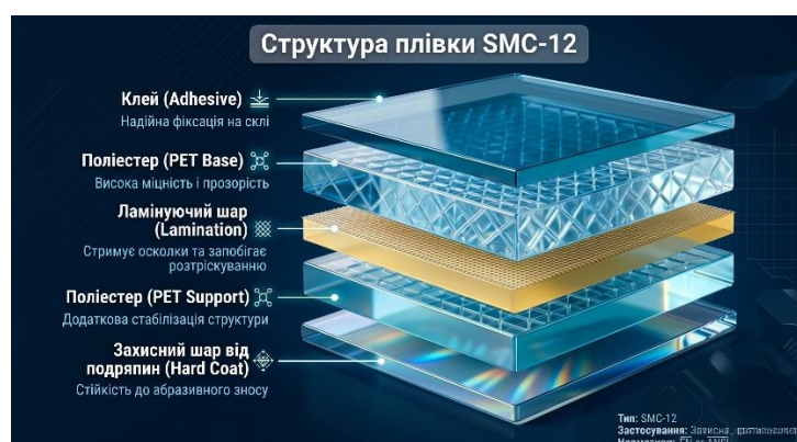
Рис. 8. Структура захисної полімерної плівки SMC 12
