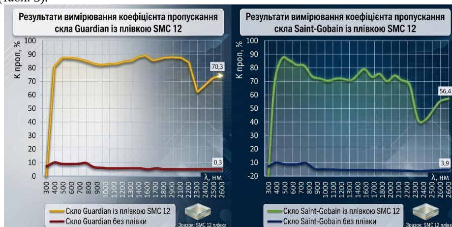
Рис. 10. Коефіцієнти пропускання скла Guardian і Saint-Gobain із нанесеною захисною плівкою SMC 12
