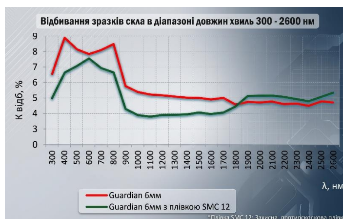
Рис. 9. Результати вимірювання коефіцієнта відбивання скла Guardian із плівкою SMC 12
