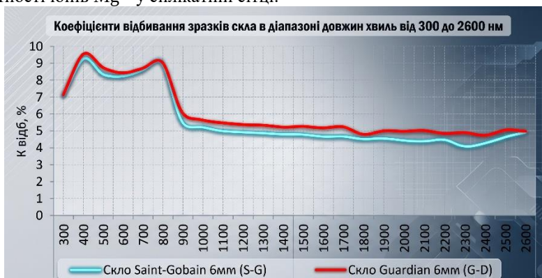
Рис. 6. Коефіцієнти відбивання зразків скла в діапазоні довжин хвиль від 300 до 2600 нм
