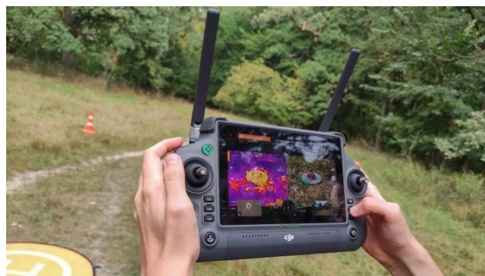
Рис. 6. Протитанкова міна ТМ-62П на пульті DJI Matrice 30T: тепловізійна та візуальна камери в режимі двох екранів
