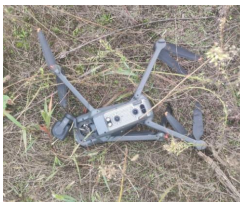
Рис. 13. Пошкоджений DJI Mavic 3 в зоні дії «жорсткої» підміни координат
