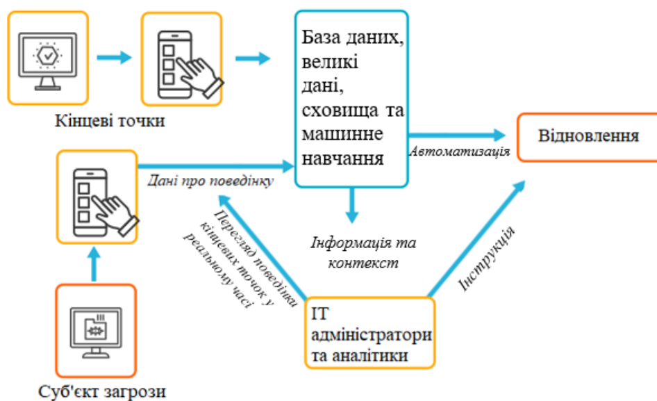
Рис. 1. Схема роботи EDR [6]
