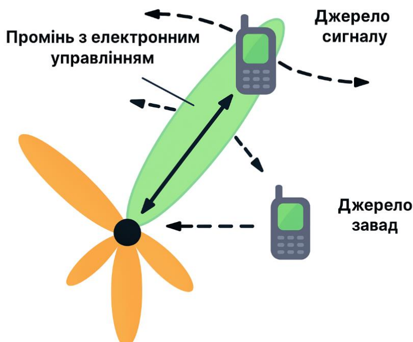
Рис. 4. Робота адаптивної антенної системи
